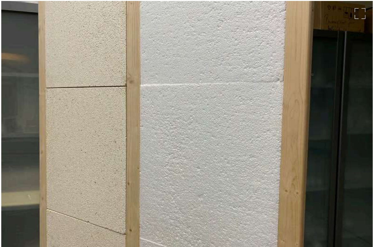
Popcorndämmung (links) und Styropordämmung. Foto: Universität Göttingen
