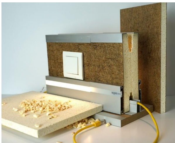
Popcorn-Granulat – das ideale Kernmaterial für Paneele aus Naturfaserlaminaten.
